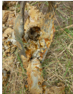
Arena fina, predomina color gris con tonalidades amarillentas y/o rojizas Estado densa.
