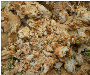
Arena fina, predomina color gris con tonalidades amarillentas y/o rojizas Estado densa.
