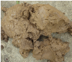
Arena arcillosa de color marón claro, consistencia blanda. Saturada.
