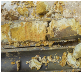
Arena fina, predomina color gris con tonalidades amarillentas y/o rojizas Estado densa.
