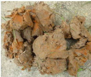
Arcilla algo arenosa, plástica. Color marrón grisácea con vetas “naranjas a rojizas”. Consistencia blanda.
