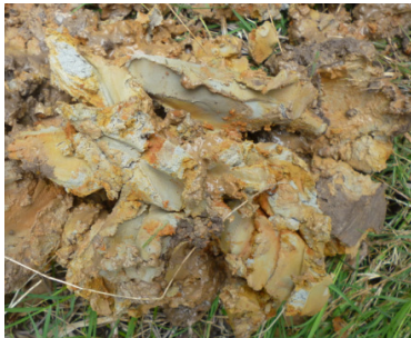
Arena fina, predomina color gris con tonalidades amarillentas y/o rojizas Estado densa.
