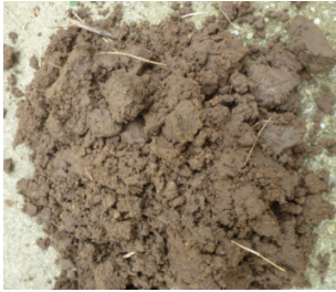
Arena algo arcillosa, estado muy suelto. Color marrón
